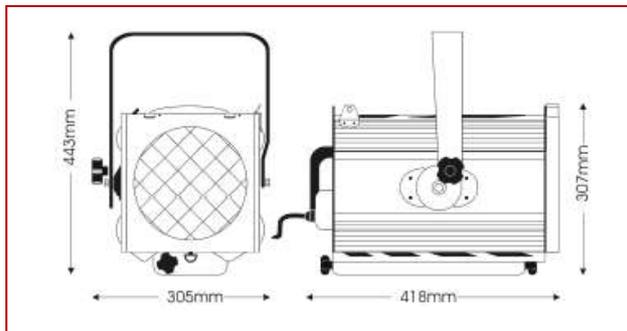
Illuminatore piano-convesso da 2/2,5 KW per uso professionale in grandi ambienti. Dispone di sportello porta-lampada basculante, robusto anello di ancoraggio secondario, efficace sistema di bloccaggio forcilla e doppio microinterruttore di sicurezza.
