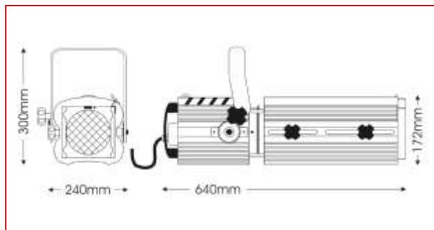
Sagomatore 650W con sistema ottico ad occhio condensatore, dall'eccellente precisione e nitida proiezione di gobo.
