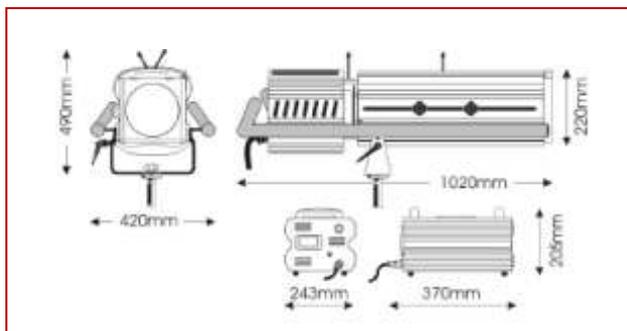
Seguipersona estremamente compatto e potente, Canto<sup>®</sup> 2000msr FF combina la flessibilità e potenza delle lampade Philips 2000msr FastFit con la nota accuratezza ottica ed affidabilità meccanica di LDR. Il risultato è questo segui persona, efficiente, leggero e dalla resa ottica strabliante; lo strumento ideale per tutti gli utilizzi su lunghe distanze.
