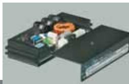
*D-Light è un'unità dimmer di dimensioni talmente compatte da poter essere incorporata nella struttura del faro (A); questa nuova concezione, trasforma in modo radicale il concetto d'unità dimmer, poiché non esisterà più l'unità dimmer e faro collegato, ma solo il faro ATTIVO, con dimmer e decodifica DMX 512 incorporata.*
